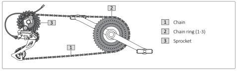
Fig. 7: Derailleur gear components
